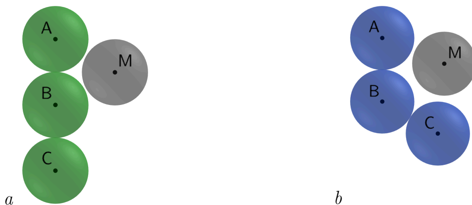
Рис. 3.1. Схематичне зображення розглянутих моделей: (а) жорсткий тример (зелений) і мономер (сірий); (б) гнучкий тример (синій) і мономер (сірий). Сегменти тримера позначено А, В, С, а мономер — М.
