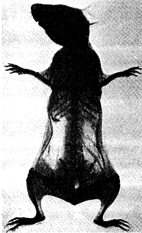
Застрілена морська свинка, сфотографована в лабораторії проф. І. Пулюя його катодною лампою за методом Рентгена (Světlozor 31. 1. 1896 р.).
