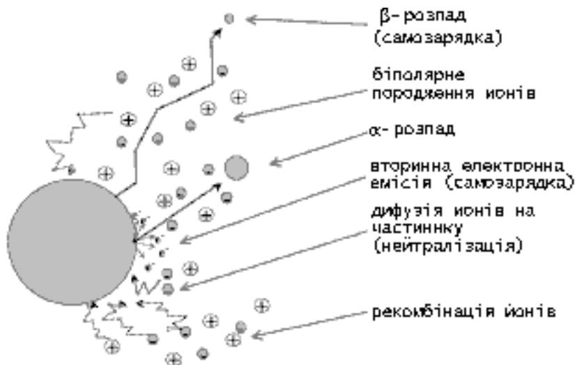
Рис. 1. Процеси переносу та накопичення зарядів в околі радіоактивної частинки.
